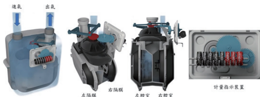
圖 3 膜式氣量計基本結構
